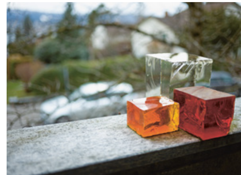
Ⓞ Bei den Glaskuben auf der Terrassenbrüstung handelt es sich um optisches Glas. Daraus werden hochwertige Linsen und farbige Lichtfilter hergestellt.
